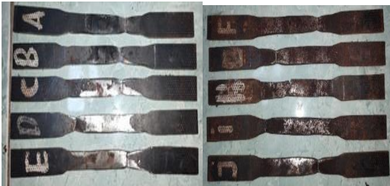
Gambar 8. Spesimen media pendingin oli dan air garam sesudah uji Tarik
