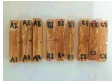
Gambar 4. Spesimen Uji Impak Komposit Serat Pohon Pisang
