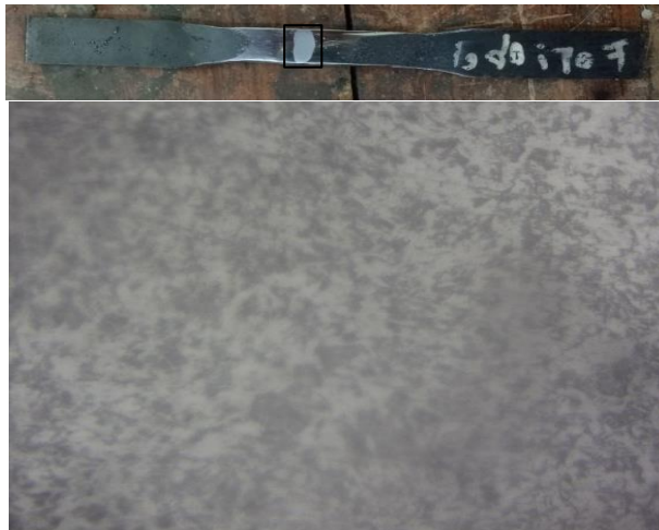
Gambar 3. Struktur tanpa quenching
