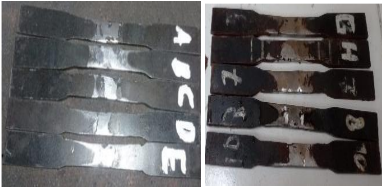
Gambar 7. Spesimen media pendingin oli dan air garam sebelum uji tarik
