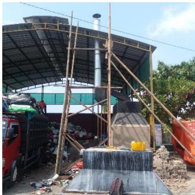
**Gambar 19. Incinerator di Depo Tompeyan siap dioperasikan**
