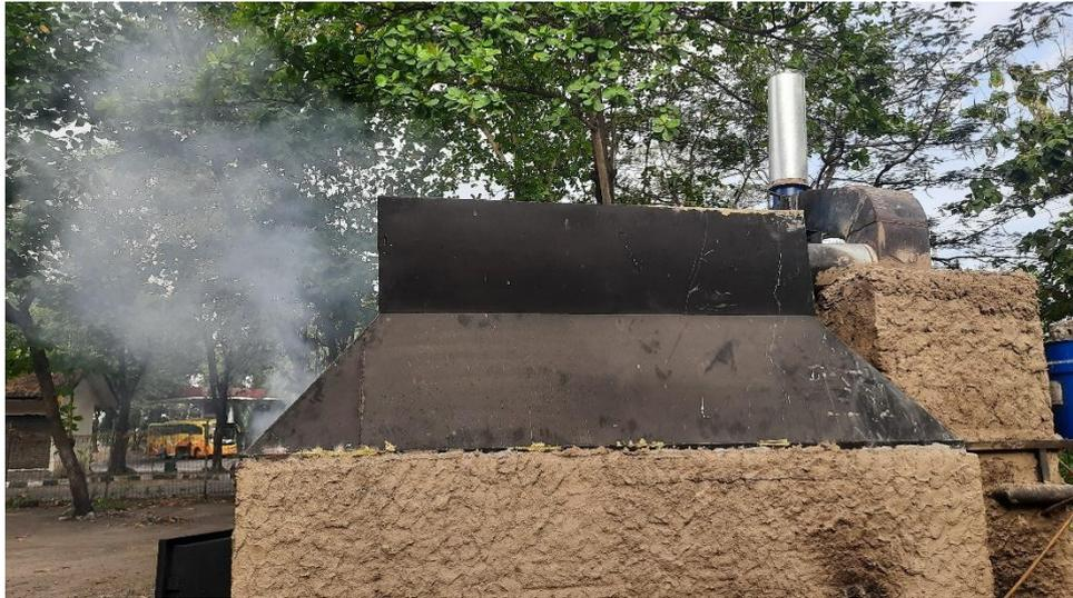
**Gambar 11.b Cerobong asap dengan Siklon sebagian Asap Mbalik**
