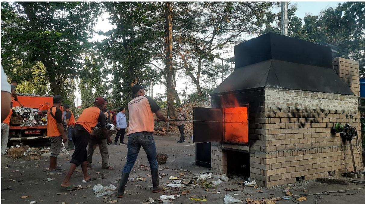
**Gambar 6. Proses Pembakaran Sempurna (temperatur 600-800 °C)**
