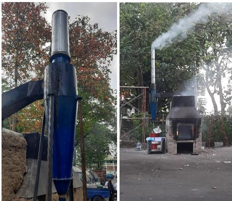
**Gambar 11.a Cerobong asap dengan Siklon, Asap tercuci**
